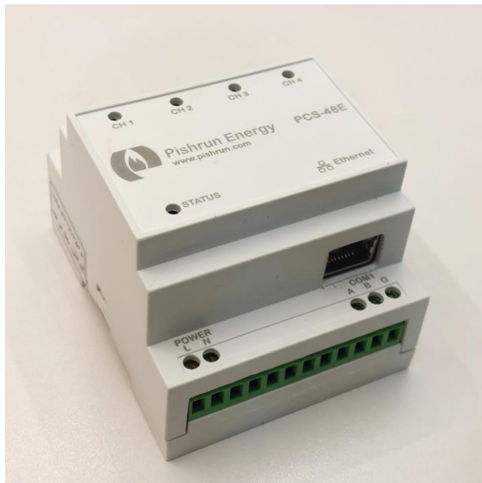
شکل ۲- یک نمونه سامانه جمع اوری و ارسال اطلاعات مصارف (شمارنده پالس)
